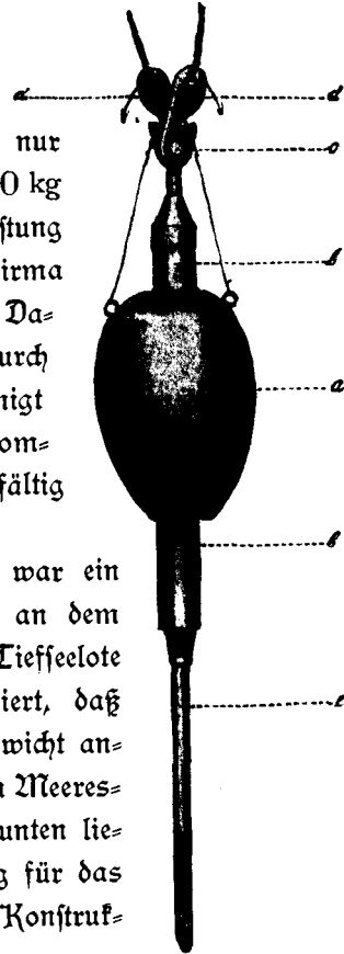
Brooke'sches Tiefseelot bei dem Herablassen. b Schlammröhre zur Gewinnung von Grundproben. (Erklärung im Text.)
